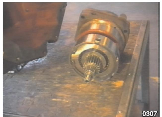
18 - Après la dépose de le Powershift complet, procéder si nécessaire à la séparation. Déposer ensuite aussi le réducteur épicycloïdal.
