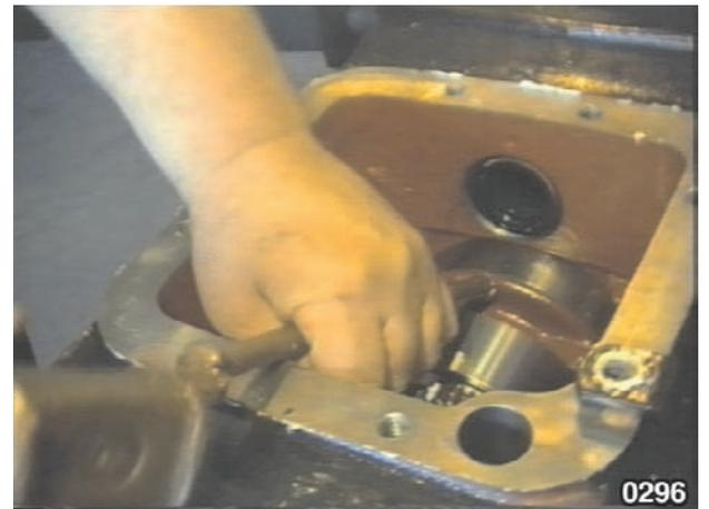
Fig. 16 - Frapper à l'aide d'un pointeau comme représenté sur la figure pour dégager le Powershift par l'avant du carter de boîte.
