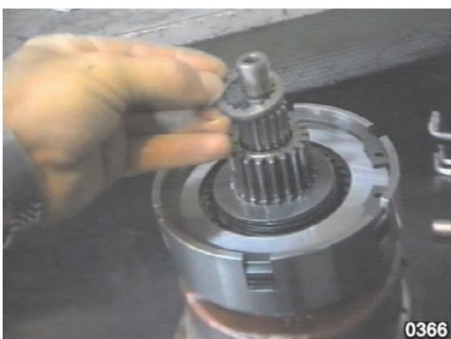
Fig. 24 - Déposer la rondelle d'appui.
