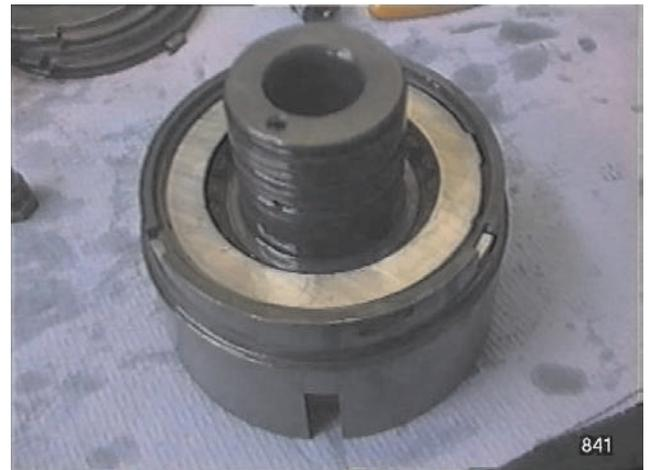
Fig. 40 - Démontez le disque de frein de l'embrayage.
