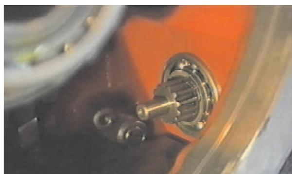
Fig. 44 - Dépose du circlip de maintien de l'arbre.
